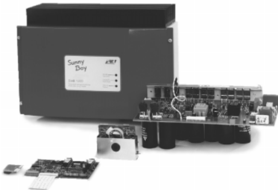
Abb. 4: Ende 1996, der erste transformatorlose String-WR (Sunny Boy 1500) mit integriertem allstromsensitivem Fehlerstromschutzschalter
